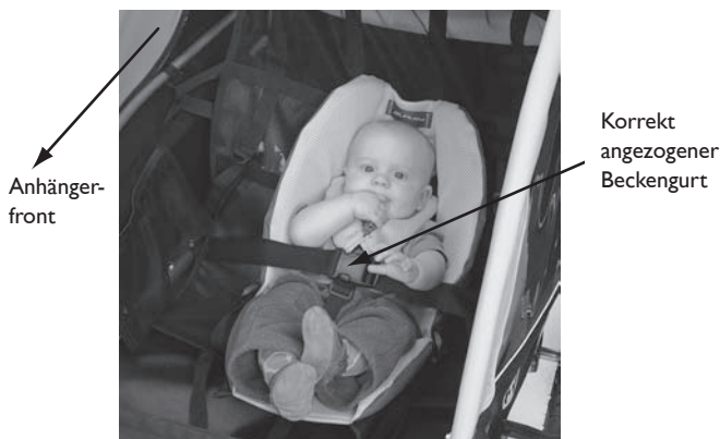
Abbildung 3: Korrekt montierter Sitzverkleinerer in Anhängermodell d'Lite
